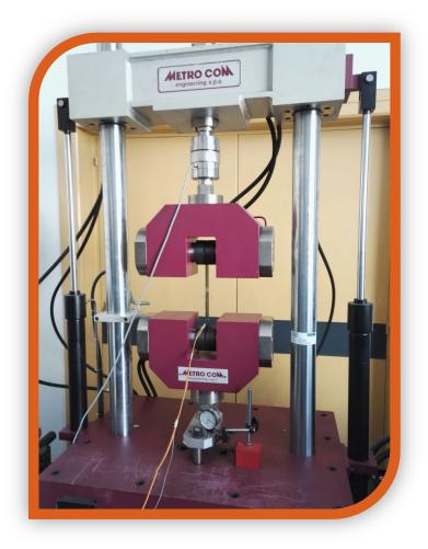
La prova sperimentale è stata condotta a trazione lungo la direzione principale del provino ed è stata eseguita mediante un martinetto idraulico con sistema di controllo retroazionato capace di fornire e controllare una specifica sequenza di carico preimpostata.
